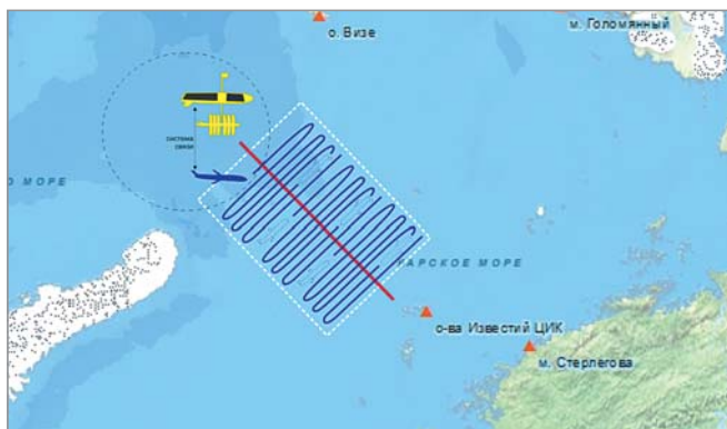
Рис. 2. Пример типовой групповой миссии для МРТК, состоящего из волнового и подводного глайдеров
