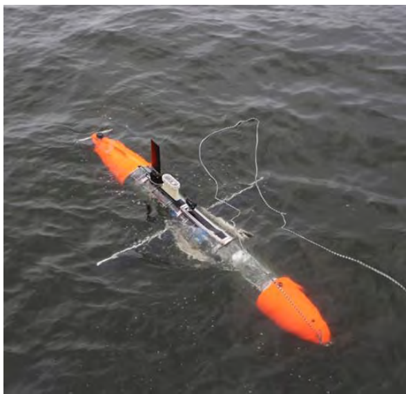
Рисунок 2-3 – Отечественные ходовые стенды подводного и волнового глайдеров в натурных экспериментах
