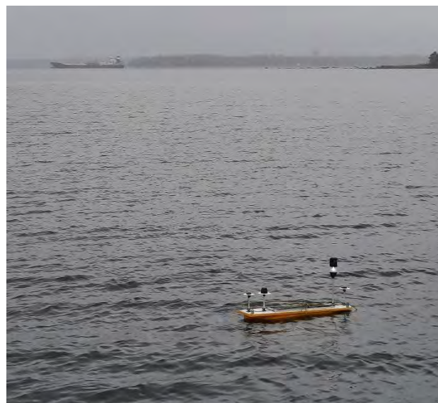
Рисунок 2-3 – Отечественные ходовые стенды подводного и волнового глайдеров в натурных экспериментах
