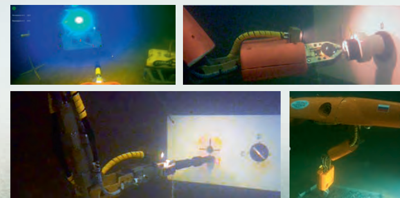
РИС. 7. Фотофиксация с экспериментов по работам демонстратора технологий ЛИ АНПА с макетами донных панелей ПДК и процесс забора грунта
