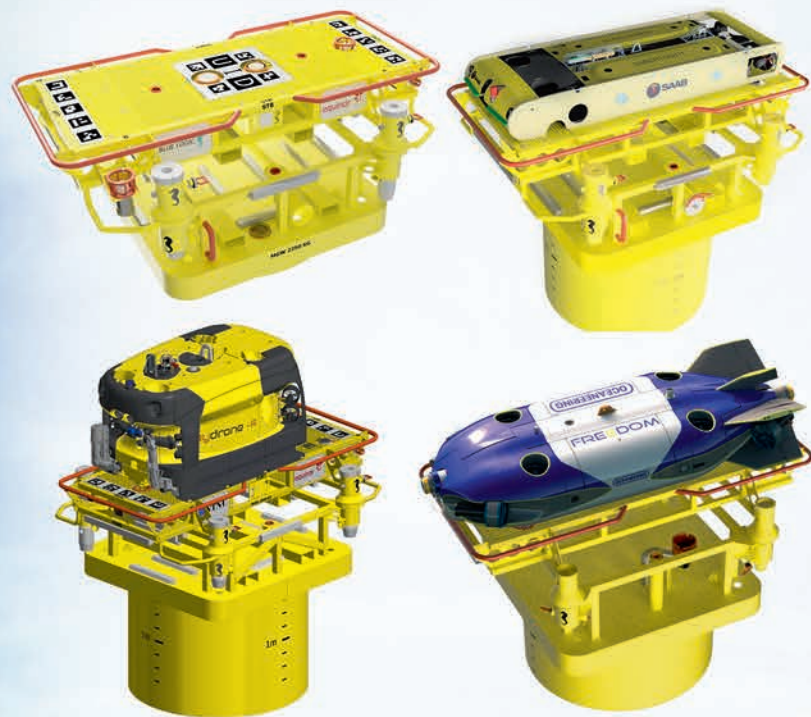
РИС. 4. Унифицированная донная доковая станция и реально апробированные варианты размещения резидентных ТНПА/АНПА
