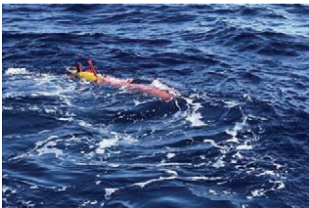
Рис. 9. Прототип АНПА Sea-Whale 2000 в период испытаний 2019 года в Южно-Китайском море (изображение взято с сайта Академии наук Китая)
