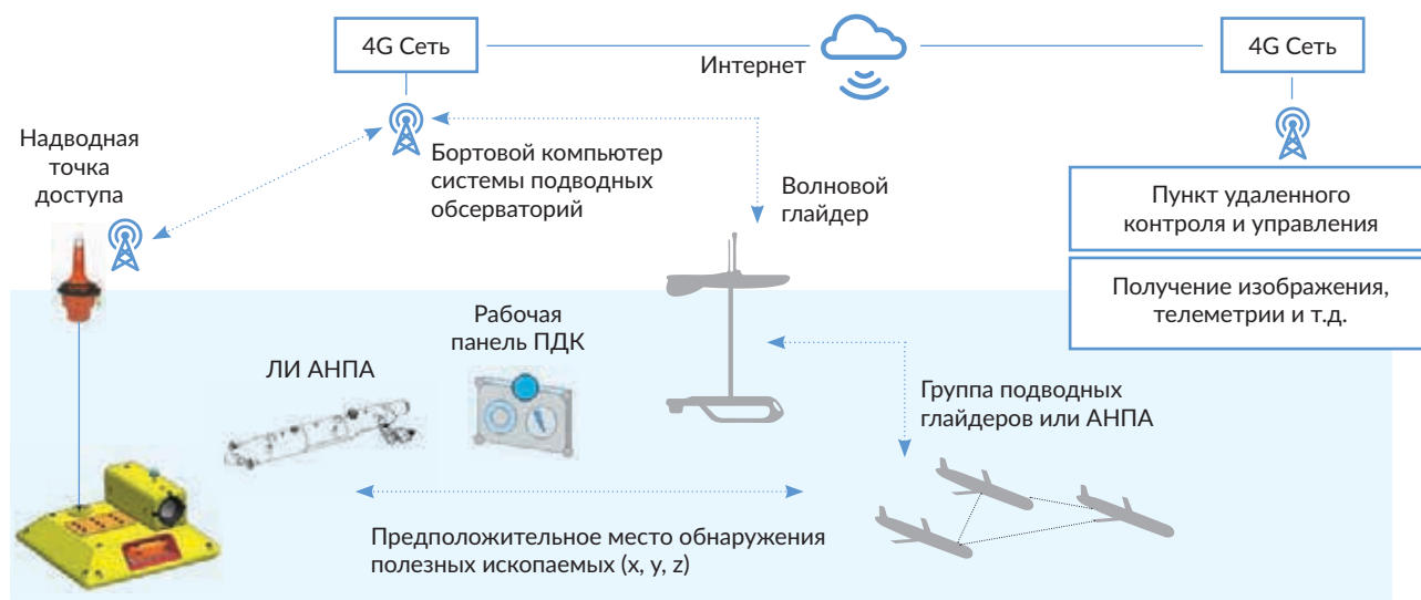
Рис. 14. Концепт работы гетерогенных групп робототехники под управлением ИИ с сопряженной системой удаленного контроля и управления
