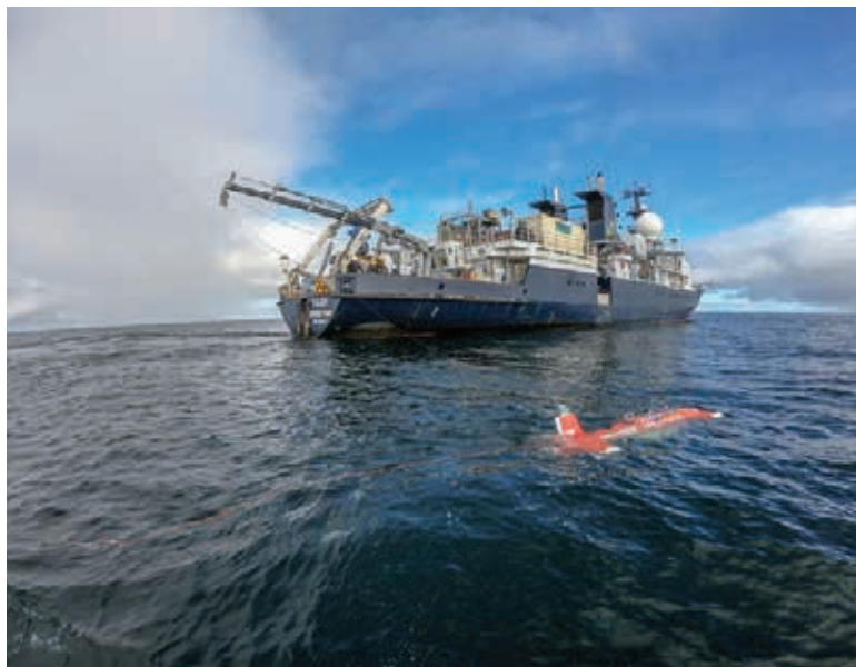
Рис. 3. АНПА AE2000f перед началом миссии
