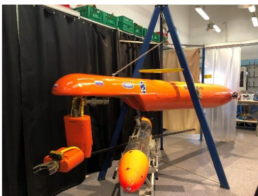
Рис. 7. Демонстратор технологий легкого интервенционного АНПА «Резидент» (вверху), подводный глайдер (внизу)
