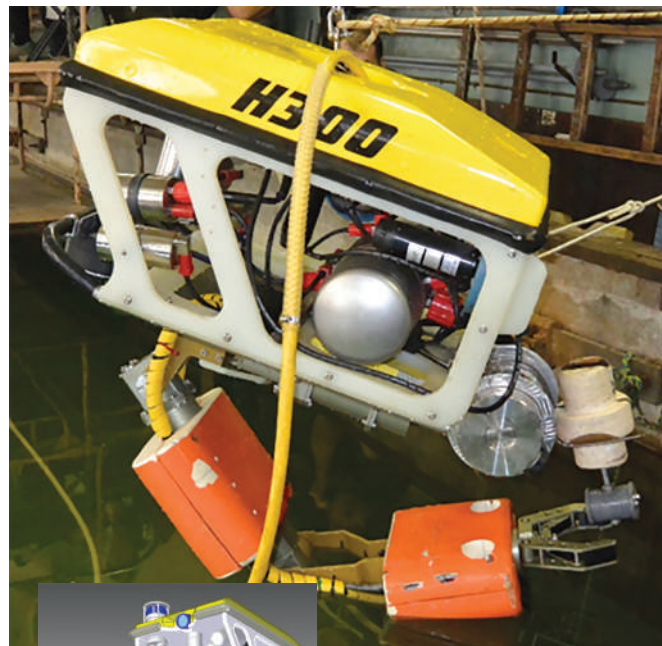
Рис. 7. 3Д моделирование манипуляторного комплекса на ТПА и фактическая отработка манипуляторного комплекса на ТПА с захватом сменного инструмента из макета инструментальной кассетницы.
