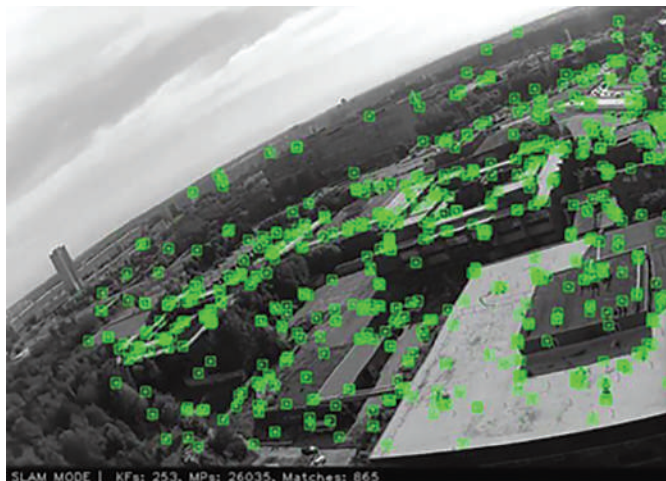
Рис. 14. Демонстрация определения положения квадрокоптера в пространстве, путем анализа только лишь видеоизображения с его камеры, без инерциальных и спутниковых навигационных систем..
