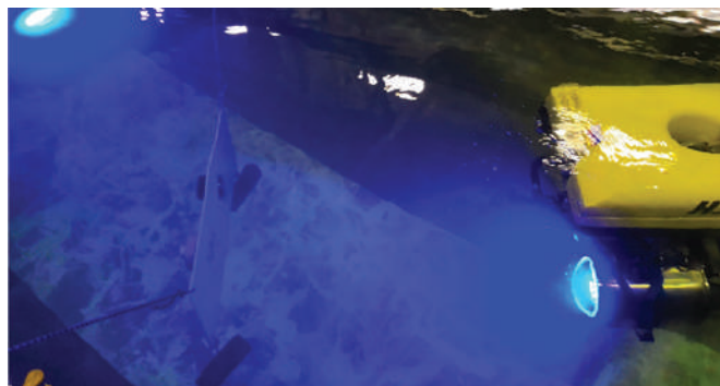
Рис. 10. Общий вид системы из стационарного приёмопередатчика, размещённого на натурном стенде и мобильного приёмопередатчика на ТПА.
