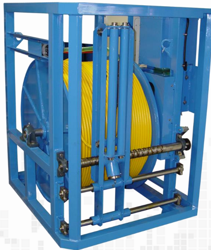
Электрическая лебедка для глубин до 1000/2000 м
