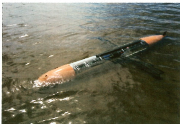
рис. 4. Глайдер в ходе натурных испытаний на открытой воде. Видны крылья и стабилизаторный блок.
