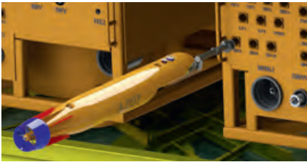
Рис. 7-8 Концепт-проект СПБГМТУ и АО «НПП ПТ «Океанос» АНПА с манипуляторным комплексом (на рис. 8 представлена для примера устьевая донная арматура TechnipFMC)
