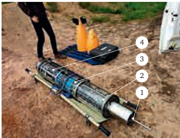
Рис. 3 Глайдер в ходе предпусковой проверки со снятыми обтекателями и крыльями (носом к камере)
