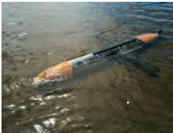
Рис. 5 Глайдер в ходе испытаний на открытой воде. Видны крылья и стабилизаторный блок
